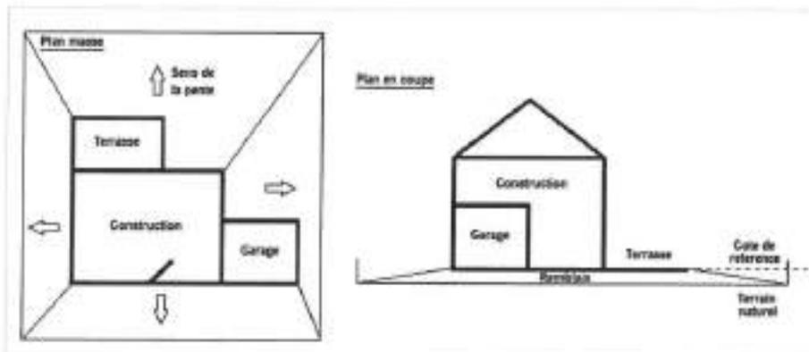
*Exemple de schéma d'une construction sur vide sanitaire avec remblais limités, AUTORISEE par le PPRI :*
