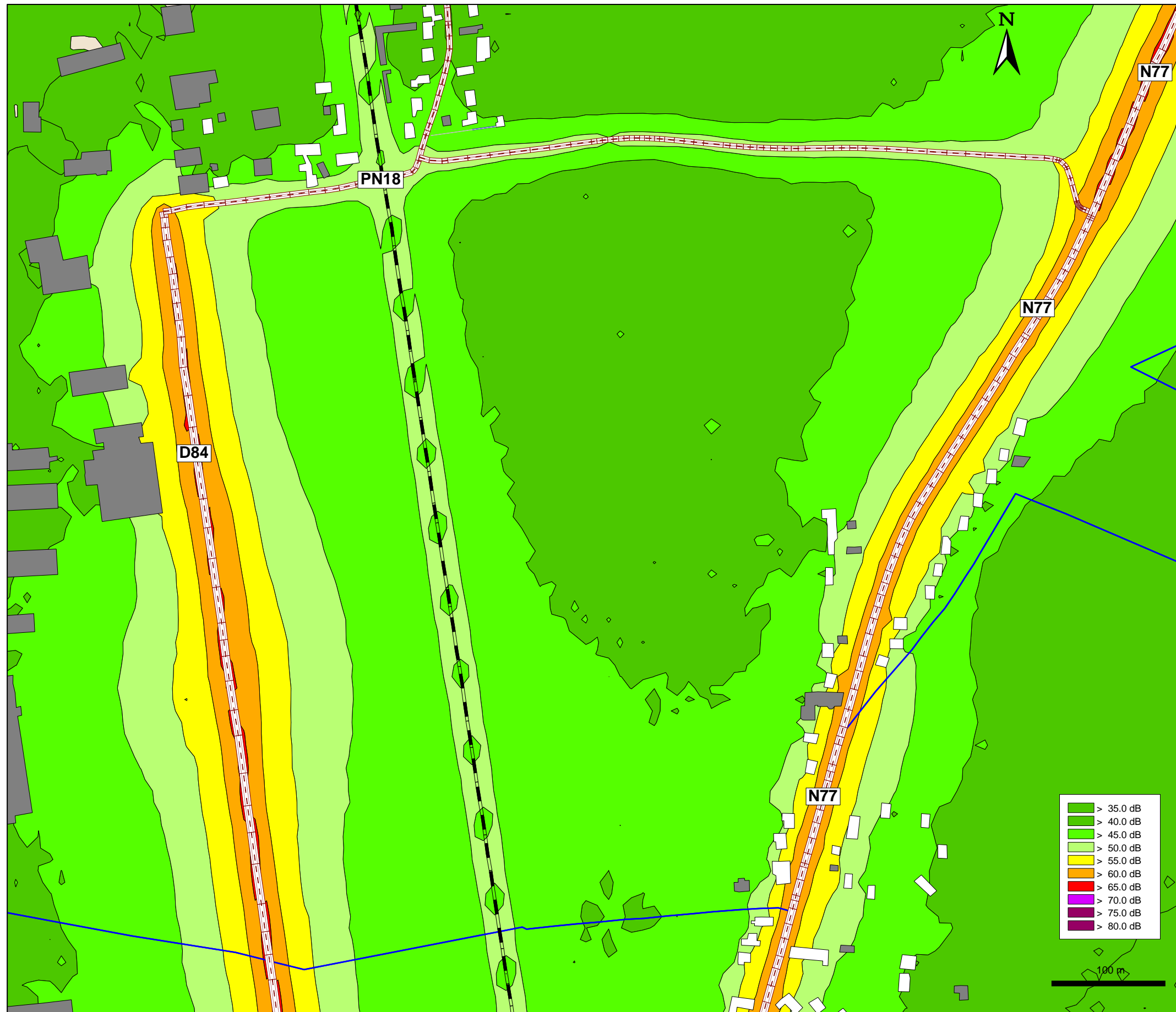
Carte de bruit à 4 m du sol en situation actuelle – Période nocturne LAeq 22h-6h – Planche 1
