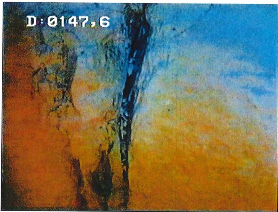
31- Trou nu – formation carbonatée massive, fracturation verticale
