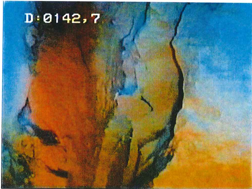
24- Trou nu – formation carbonatée massive, fracturation verticale
