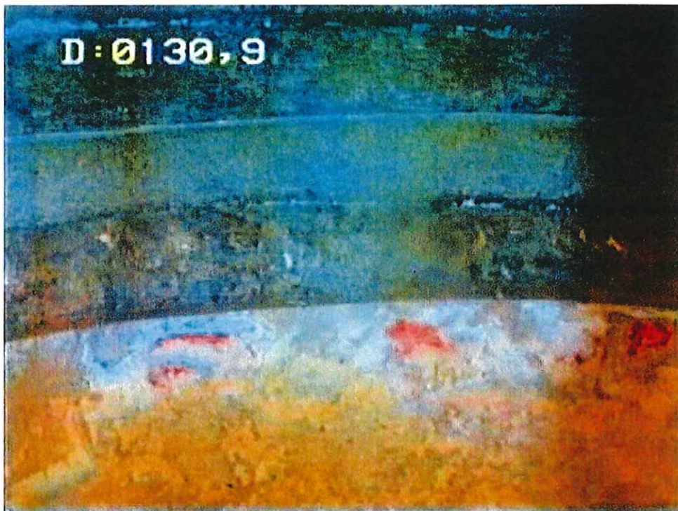
13- Tubage acier plein – base du sabot, ciment
