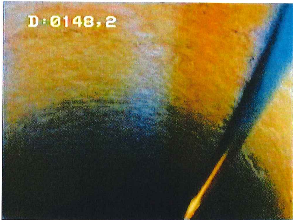
32- Trou nu – formation carbonatée massive
