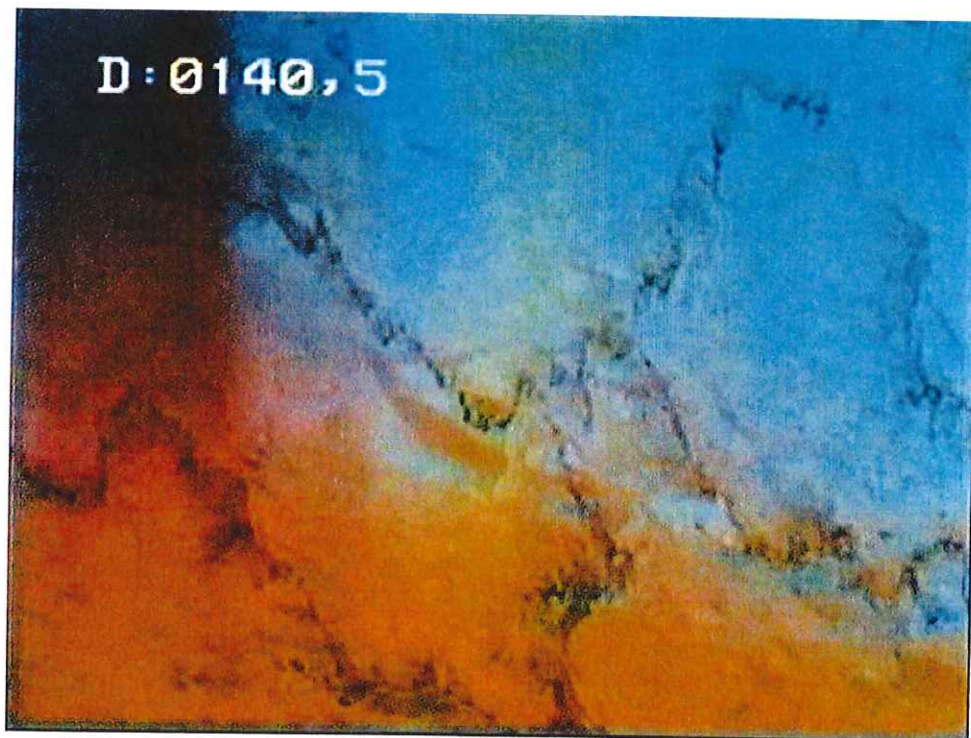
20- Trou nu – formation carbonatée massive avec stylolites (7)
