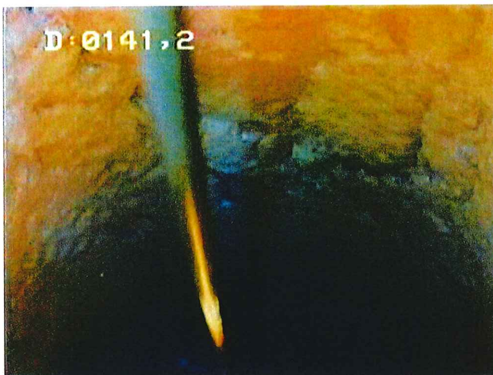
21- Trou nu – formation carbonatée massive
