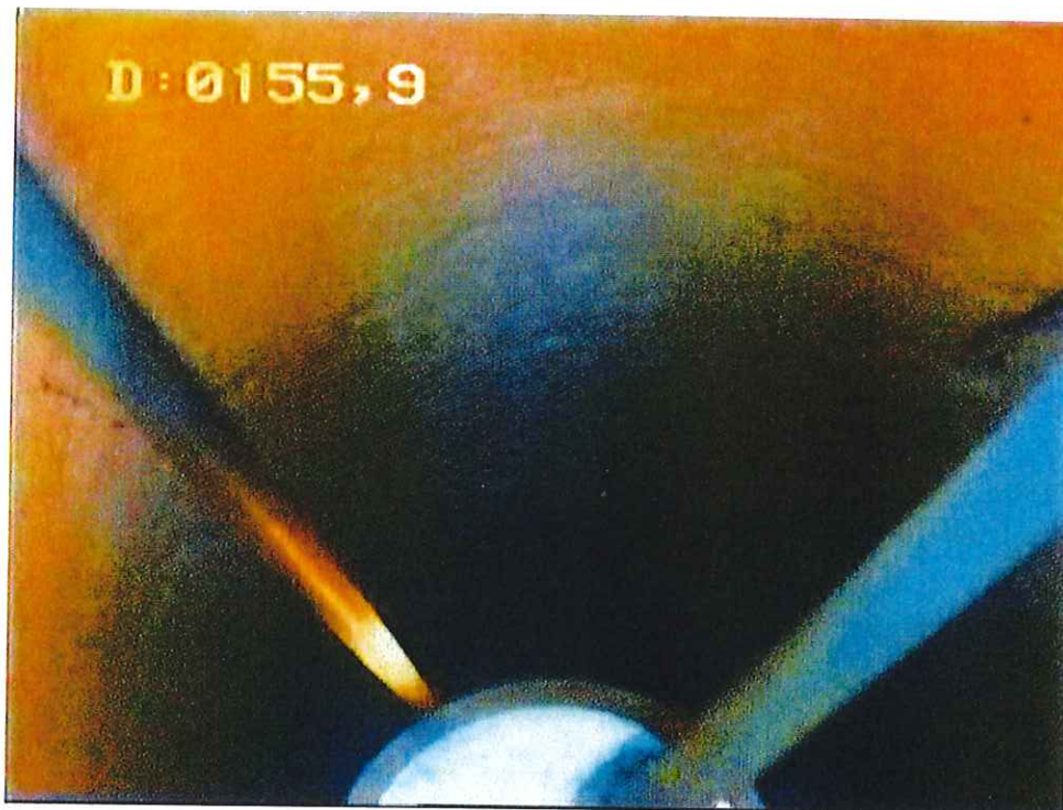
40- Trou nu – formation carbonatée massive
