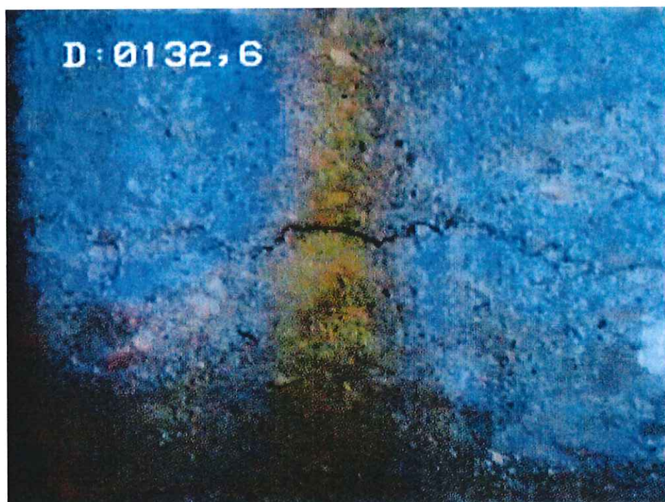
18- Trou nu – formation carbonatée massive
