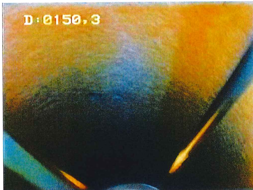
34- Trou nu – formation carbonatée massive
