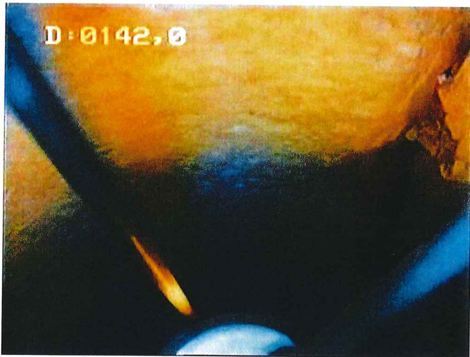
23- Trou nu – formation carbonatée massive, fracturation verticale
